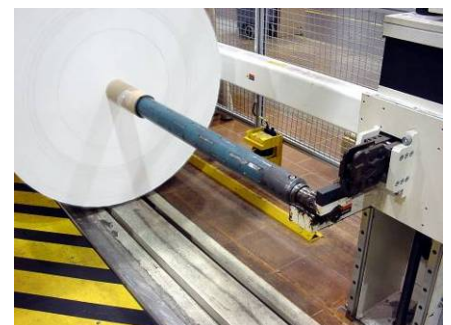
Wickelwellen-Halteeinrichtung in Kombination mit einem Flurförderer
