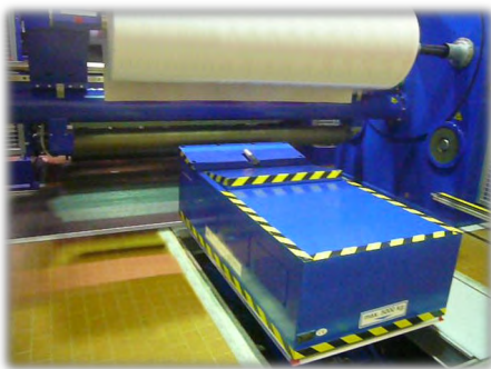
Rollenentnahme mit Hubtisch
