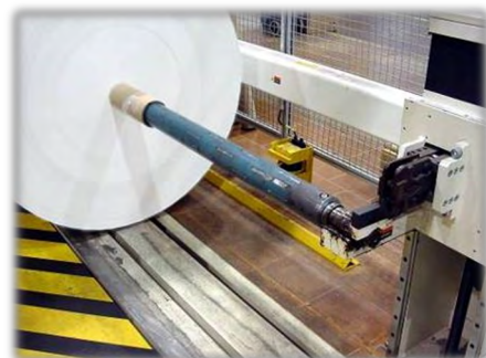
Wickelwellen-Halteeinrichtung in Kombination mit einem Flurförderer
