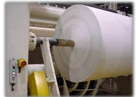
Entnahmegabeln zur Ablage der Rolle auf Fußboden-Niveau
