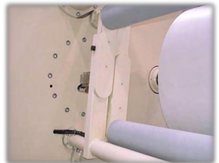
Reiterwalzen zur Optimierung der Wickelqualität beim Rollenwechsel
