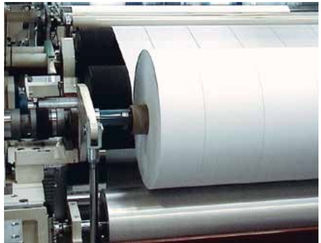
Supportwalze beim Wickelvorgang
