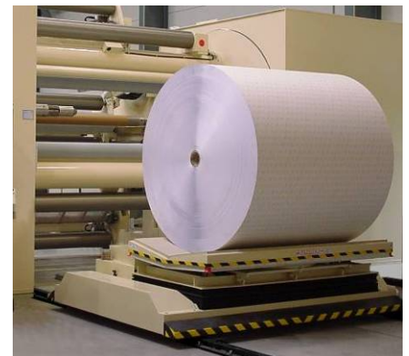
Automatisches Rollenhandling mit motorisch verfahrbarem Rollen-Entnahmewagen
