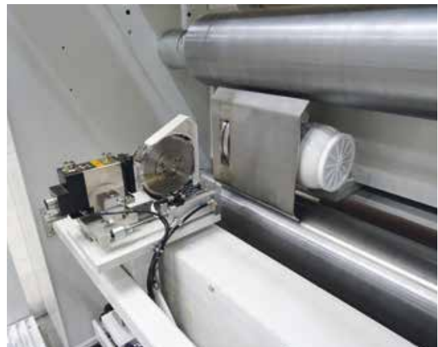
Automatisches Längsschneidsystem nach dem Scherenschnittprinzip mit integrierter Absaugung
