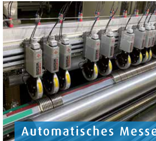
Automatisch einstellbare Ober- und Untermesser
