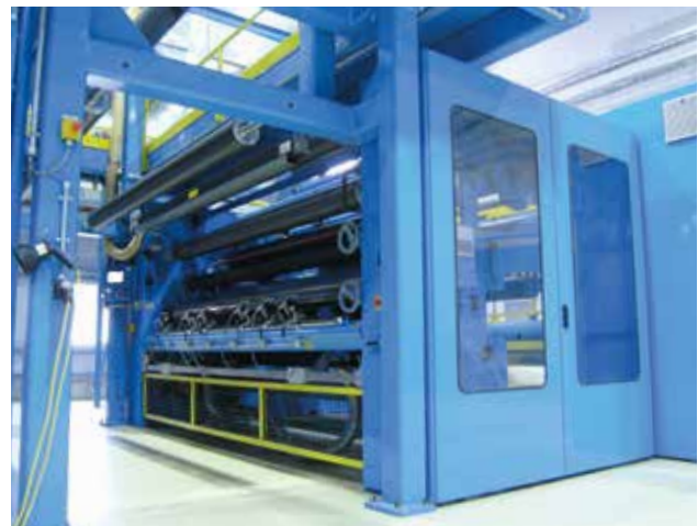
Einlaufteil mit integrierter Pendelwalze und Längsschneidsystem
