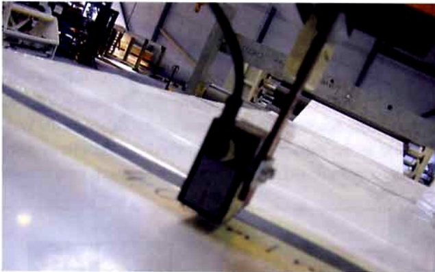
Abb. 1: Ein Kontrast-Band zeigt einem Sensor an, wo die abgetrennte vorherige Bahn endet.
