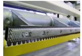
Automatisches Rollenwechselsystem TAC kurz vor dem Schnitt
