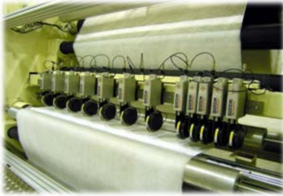
Mehrnutzschnitt als Scherenschnitt
