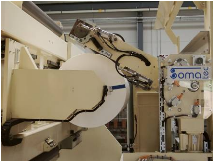
Abwickler UW 1500 S: Splicevorgang unten
