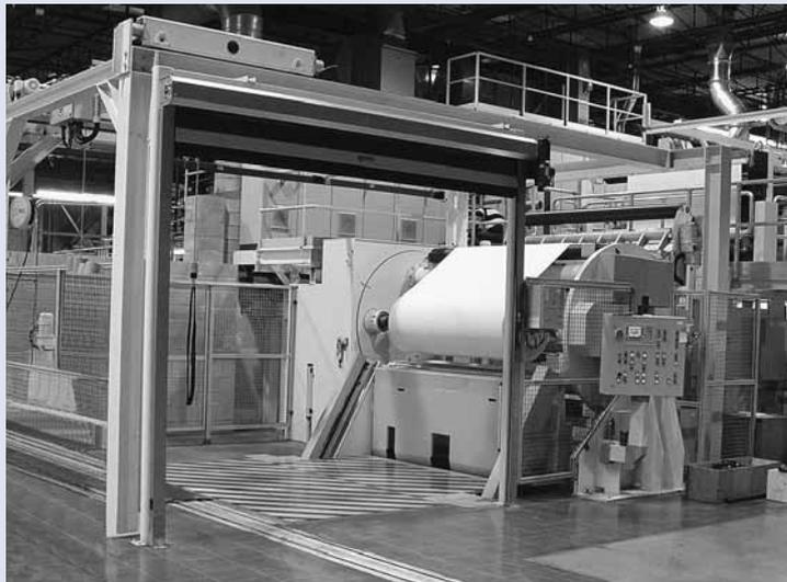
Abb. 4: Automatischer Aufwickler mit Supportwalze.
